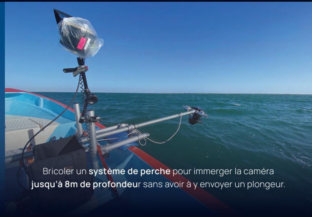
Bricoler un **système de perche** pour immerger la caméra jusqu'à **8m de profondeur** sans avoir à y envoyer un plongeur.
